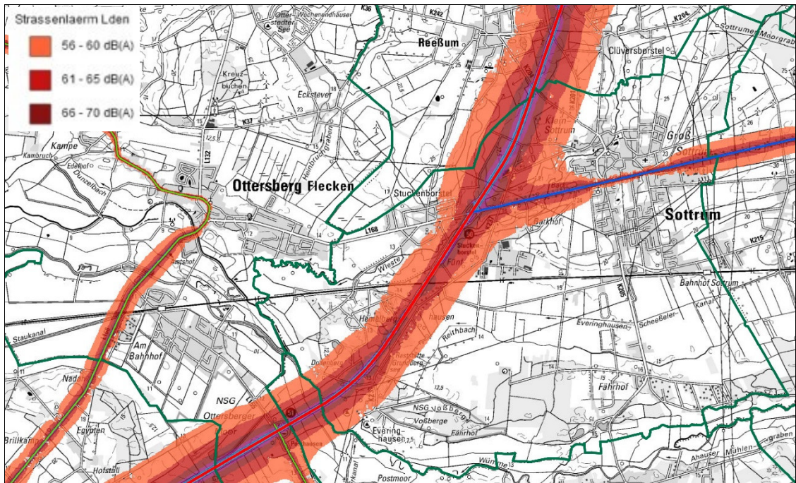
Abbildung 14: Lärmkarte Straßenlärm Sottrum L den (24 h)
